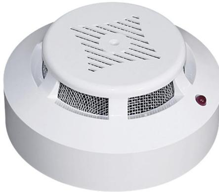
Это прибор, реагирующий на определенный уровень концентрации аэрозольных продуктов горения (пиролиза) веществ и материалов, в корпусе которого конструктивно объединены автономный источник питания и компоненты, необходимые для обнаружения пожара и непосредственного оповещения о нем. Если говорить простым языком – это прибор, работающий автономно от батарейки и подающий громкий звуковой сигнал при появлении дыма в помещении.
